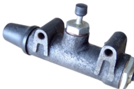
Glavni cilindar 1468328 - \phi 25,4 Viljuškara POBEDA TU - 35
